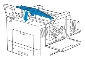
13 Inclinez le panneau de commande vers l'arrière à sa position d'origine.
