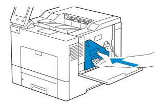
**10** Faites pivoter le collecteur de toner de 90 degrés dans le sens des aiguilles d'une montre afin de le verrouiller.
