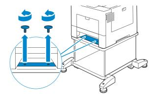
**4** Dégagez doucement l'imprimante du casier à roulettes et posez-la sur une surface plane.
