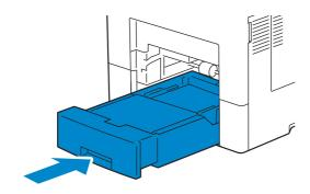
7 Insérez le plateau d'alimentation auxiliaire dans l'imprimante.
