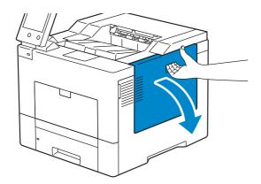
**2** Faites pivoter le collecteur de toner de 90 degrés dans le sens inverse des aiguilles d'une montre, afin de le déverrouiller.
