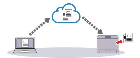
La version 2.0 du service Google Cloud Print<sup>TM</sup> envoie les données d'impression à l'imprimante via Internet ou via le réseau local. Cette version est recommandée dans les environnements où il est impossible d'utiliser une connexion Internet.
