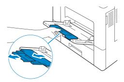
**3** Faites glisser les guides de largeur sur les bords du bac. Les guides de largeur doivent être complètement étendus.
