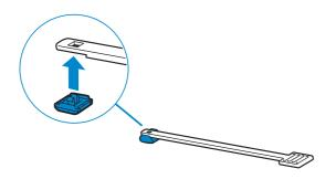
**9** Insérez complètement la tige de nettoyage dans l'un des quatre trous jusqu'à ce qu'elle s'enclenche à l'intérieur de l'imprimante comme illustré ci-dessous ; puis retirez-la.
