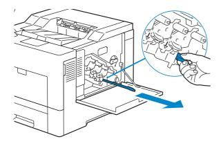
**6** Insérez complètement la tige de nettoyage dans l'un des quatre trous jusqu'à ce qu'elle s'enclenche à l'intérieur de l'imprimante comme illustré ci-dessous ; puis retirez-la.
