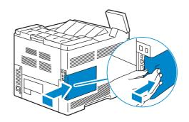
7 Tournez la vis dans le sens des aiguilles d'une montre.
