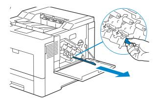
**6** Retirez le tampon de nettoyage en pressant les ergots blancs entre le pouce et l'index.
