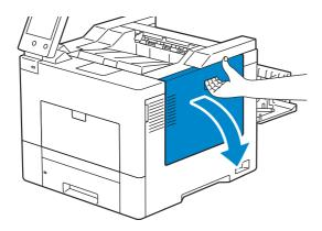
**4** Faites pivoter le collecteur de toner de 90 degrés dans le sens inverse des aiguilles d'une montre, afin de le déverrouiller.
