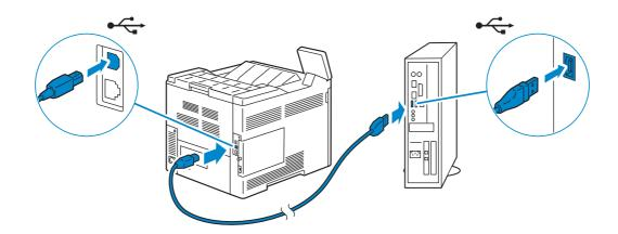
2 Connectez l'autre extrémité du câble au port USB de l'ordinateur.
