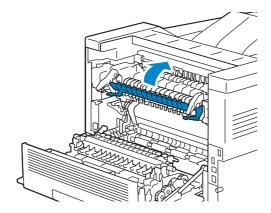
7 Pressez vers le bas les deux leviers du module de fusion, puis fermez le capot arrière.
