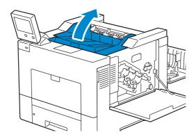
**9** Placez vos doigts dans les boucles des deux côtés de la courroie de transfert, et tirez-le hors de l'imprimante.
