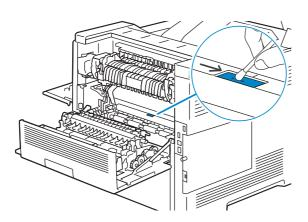
**11** Alignez les flèches de la courroie de transfert avec celles de l'imprimante, puis insérez le module dans l'imprimante jusqu'à enclenchement.
