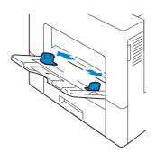
**4** Insérez tous les supports face vers le haut avec le bord supérieur en premier dans le plateau d'alimentation auxiliaire.
