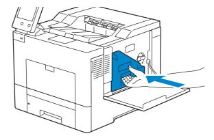
**3** Faites pivoter le collecteur de toner de 90 degrés dans le sens des aiguilles d'une montre afin de le verrouiller.
