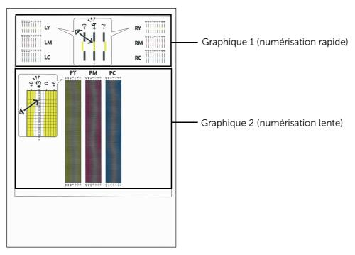
Le graphique 1 est utilisé pour le repérage des couleurs dans le sens de numérisation rapide, c'est-à-dire perpendiculairement au sens d'alimentation du papier. Le graphique 2 est utilisé le repérage des couleurs dans le sens de numérisation lente, c'est-à-dire dans le sens d'alimentation du papier.
