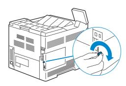
8 Replacez le capuchon déposé lors de l'installation de l'adaptateur sans fil.
