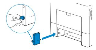
**4** Poussez et tournez la butée de 90 degrés dans le sens horaire jusqu'à ce que le triangle sur la butée soit aligné avec celui sur l'extension.
