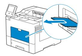
2 Saisir le capot du plateau d'alimentation auxiliaire des deux côtés, et tirez-le doucement hors de l'imprimante.
