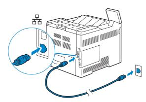
Pour raccorder l'imprimante au réseau, branchez une extrémité d'un câble Ethernet dans le port Ethernet situé à l'arrière de l'imprimante et l'autre extrémité à un branchement ou concentrateur LAN.
